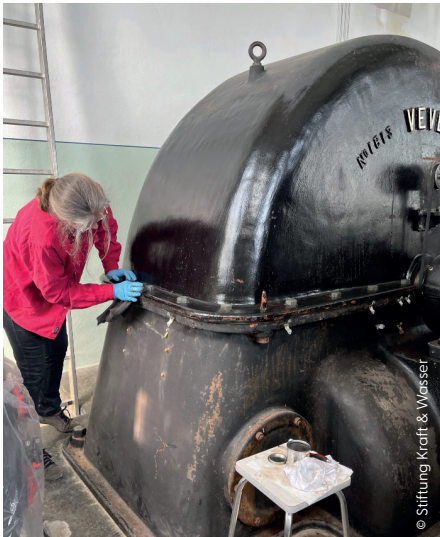
Mit Liebe zum Detail behandelt Edith Biedermann die Gussteile mit Auffrischöl.
