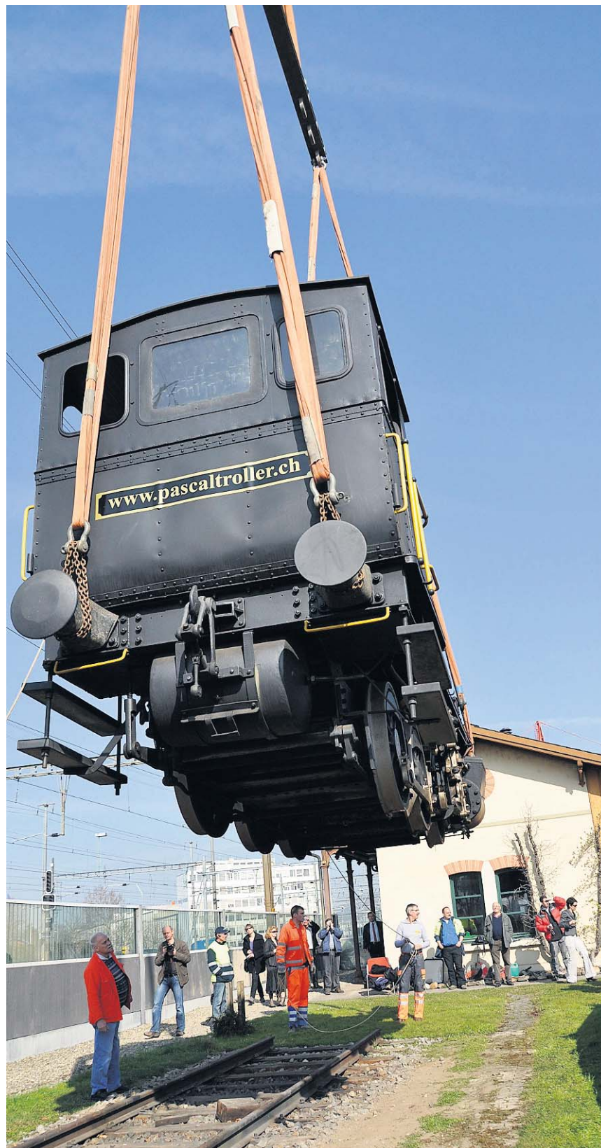
Schritt 2: Rund 21 Tonnen Eisen schweben in der Luft.
