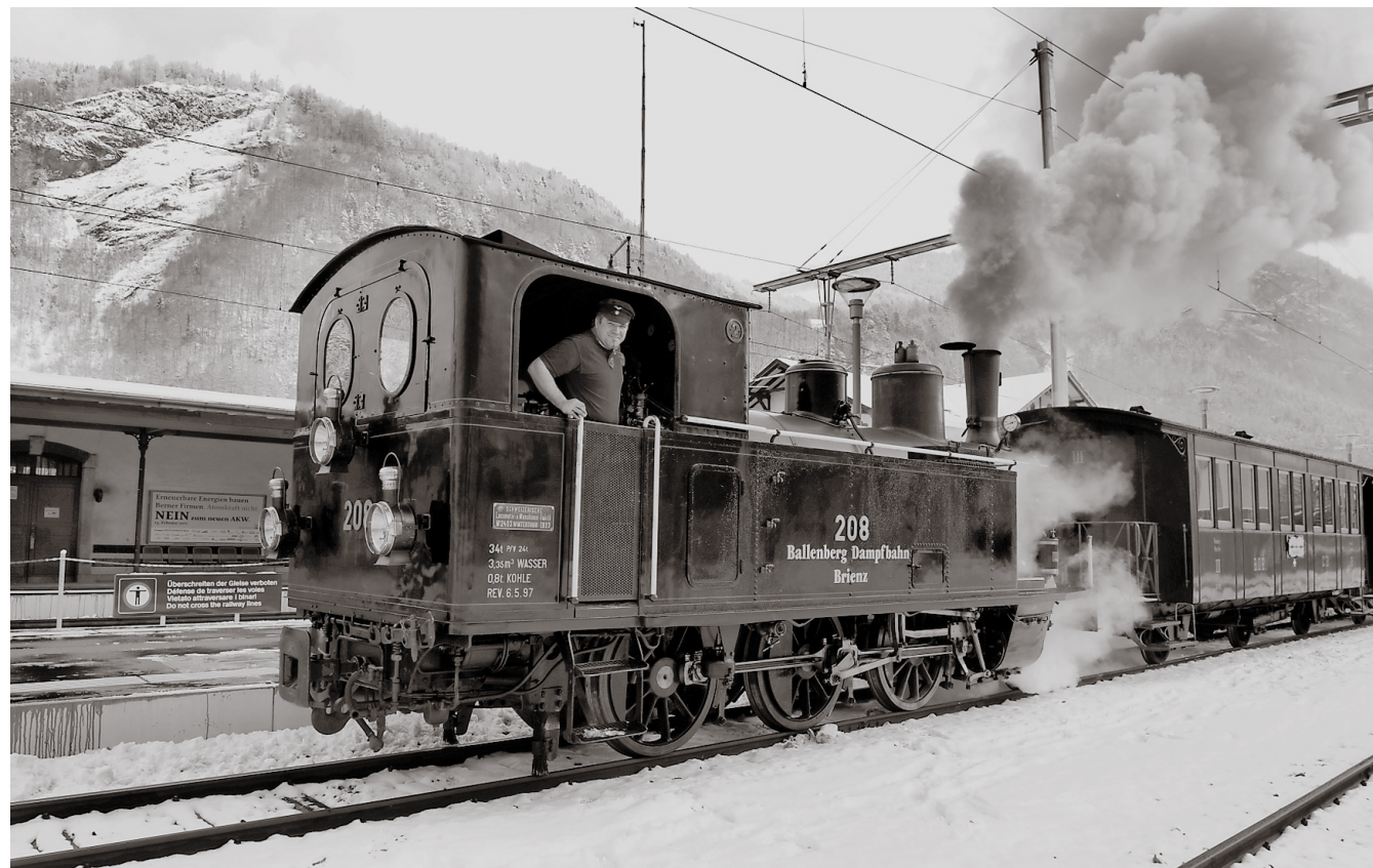
Wegen fehlender Drehscheibe muss die Dampflokomotive rückwärts zurück nach Interlaken fahren. Foto: Franziska Scheidegger
